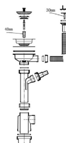
**ВЫПУСК С СИФОНОМ ДЛЯ КОМПОЗИТНОЙ КУХОННОЙ МОЙКИ с отводом для стиральной машины
