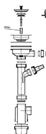
**ВЫПУСК С СИФОНОМ ДЛЯ КОМПОЗИТНОЙ КУХОННОЙ МОЙКИ с отводом для стиральной машины
