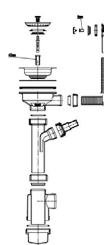
**ВЫПУСК С СИФОНОМ ДЛЯ КОМПОЗИТНОЙ КУХОННОЙ МОЙКИ с отводом для стиральной машины
