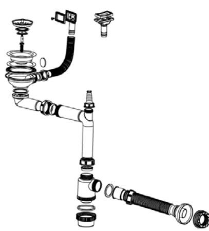
**ВЫПУСК С СИФОНОМ для НЕРЖАВЕЮЩЕЙ КУХОННОЙ МОЙКИ с отводом для стиральной машины и гибкой трубой
