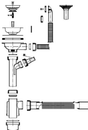
**ВЫПУСК С СИФОНОМ для НЕРЖАВЕЮЩЕЙ КУХОННОЙ МОЙКИ с отводом для стиральной машины и гибкой трубой
