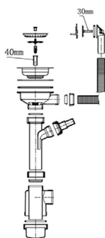
**ВЫПУСК С СИФОНОМ ДЛЯ КОМПОЗИТНОЙ КУХОННОЙ МОЙКИ с отводом для стиральной машины
